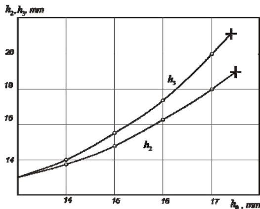
Figure 5. Levitation gaps  $h_2$ ,  $h_3$  versus spacing  $h_0$ .
