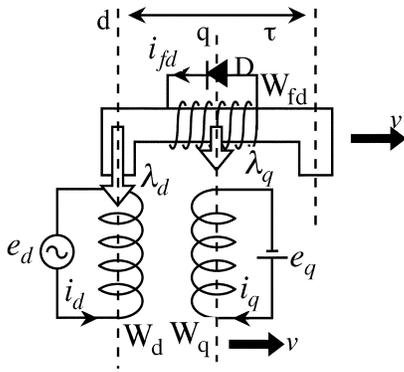
Fig. 2. Equivalent Model on the dq-Axis.
